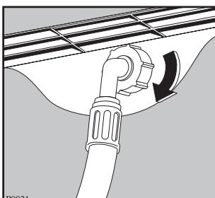
Другой конец наливного шланга, подключающийся к машине, может быть повернут в любом направлении. Ослабьте гайку, поверните шланг и вновь затяните гайку, проверив отсутствие течией воды. Наливной шланг нельзя вытягивать. Если он слишком короткий, и вы не хотите передвигать кран, то вам следует купить новый, более длинный шланг, специально предназначенный для данных целей.
